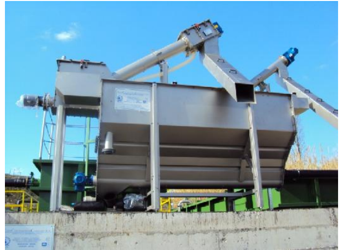
Μονάδα Προεπεξεργασίας (Εσχάρωση – Αμμοσυλλέκτης – Λιπосуλλέκτης)
