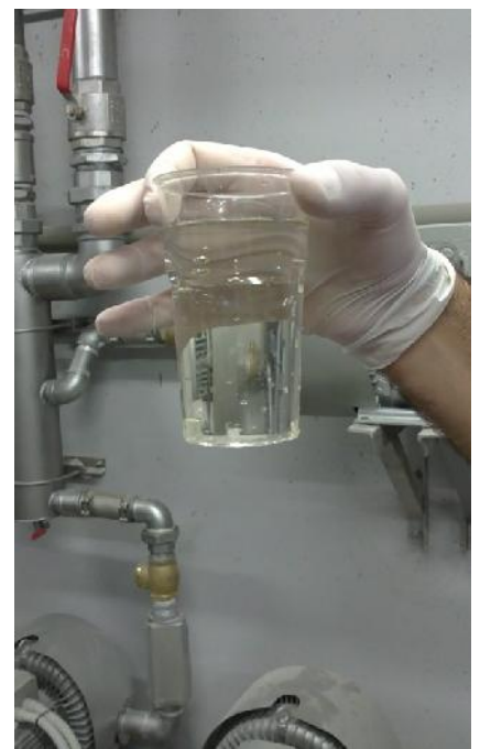
Επεξεργασμένο υγρό BOD<10mg/lit
